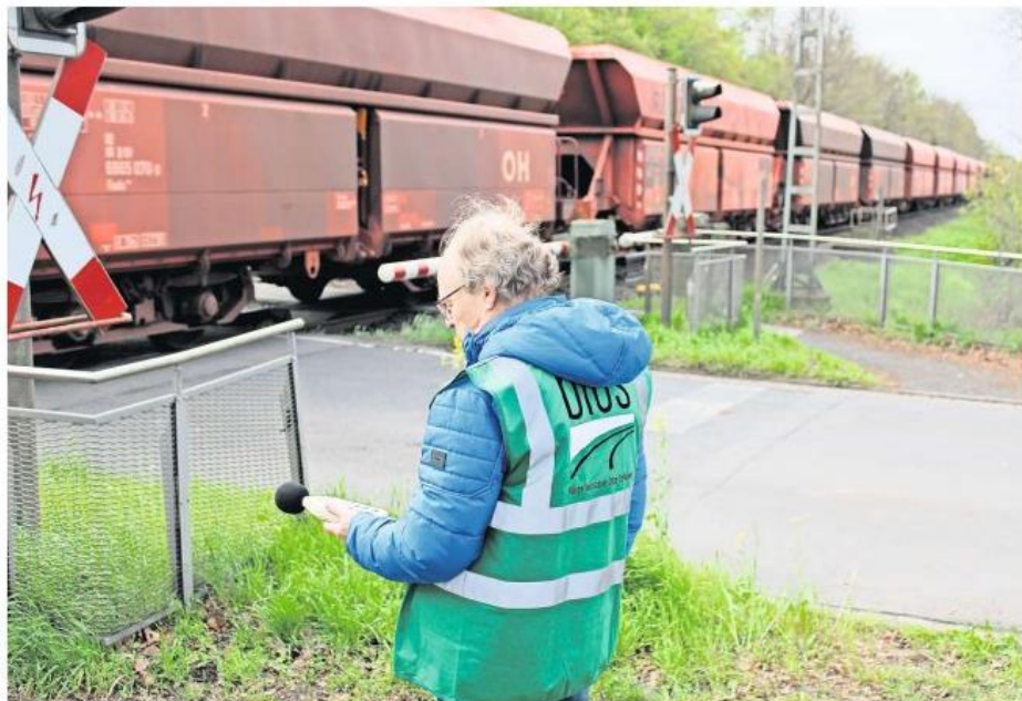
Messen: Arnim Goldbach misst den Lärmpeak des durchrauschenden Güterzugs am Bahnhof Otze.
